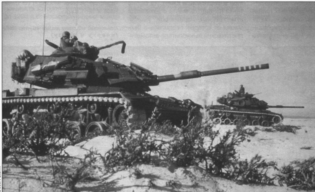
Танки М60А3 Корпуса морской пехоты США, оснащенные навесной динамической защитой, на боевых позициях в Аравийской пустыне. Осень 1990 года
