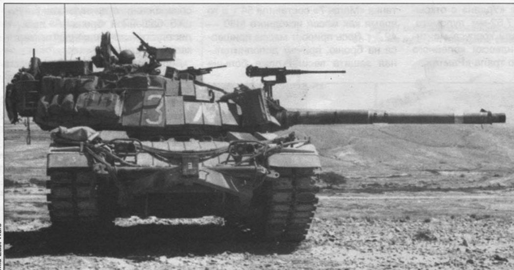
Израильский М60А1, оснащенный комплектом динамической защиты «Блэйзер». Начало 1980-х годов
