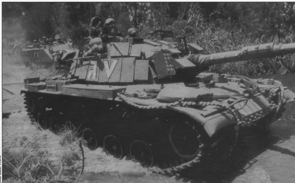
Танк «Магач 6», оснащенный катковым минным тралом, во время тактических занятий в пустыне Неgev. 1980-е годы (фото вверху). «Магач 6В» во время учений. На лобовой броне башни слева и справа от пушки установлены блоки дымовых гранатометов CL-3030
