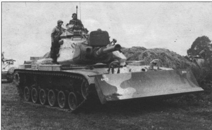
Танк М60А1 с бульдозерным оборудованием М9. 1-я пехотная дивизия, учения «Рефорджер 5», Германия, 1973 год
