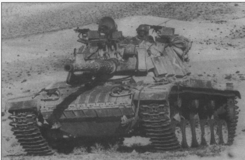
«Магач 6В» со стальными гусеницами, заимствованными у танка «Меркава»
